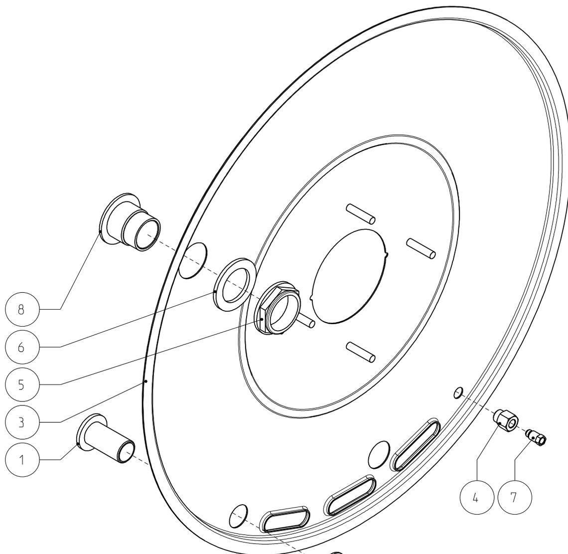
**NOTA: il fondello della macchina NON è predisposto per la connessione vapore. Per il collegamento del vapore il fondello viene forato in fabbrica PRIMA della consegna della macchina. Per questo motivo il collegamento vapore NON può essere effettuato su macchine già consegnate.**
