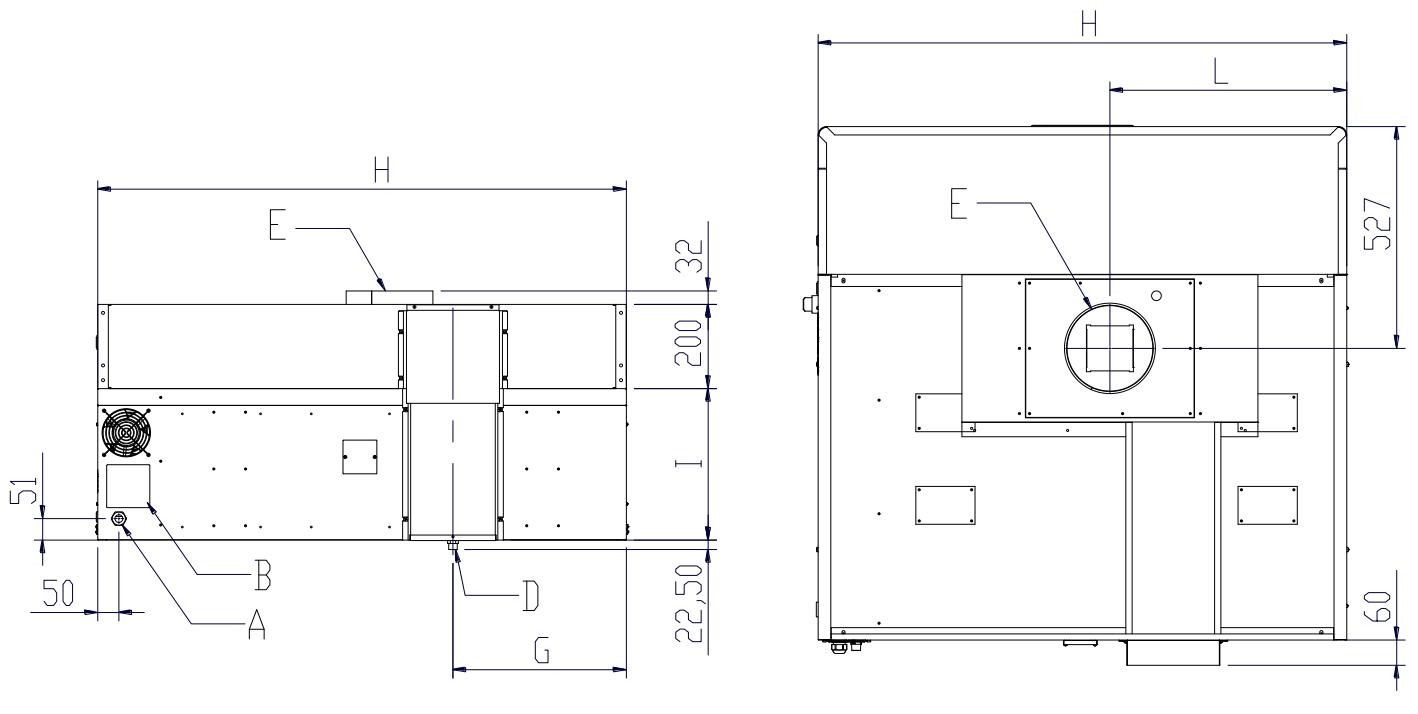
**Modulo con cappa aspirante 600m<sup>3</sup>/h, module with 600m<sup>3</sup>/h extractor fan hood, módulo con capa aspirante 600 m<sup>3</sup>/h, module avec hotte d'aspiration 600m<sup>3</sup>/h, Modul mit Abzugshaub 600m<sup>3</sup>/h**
