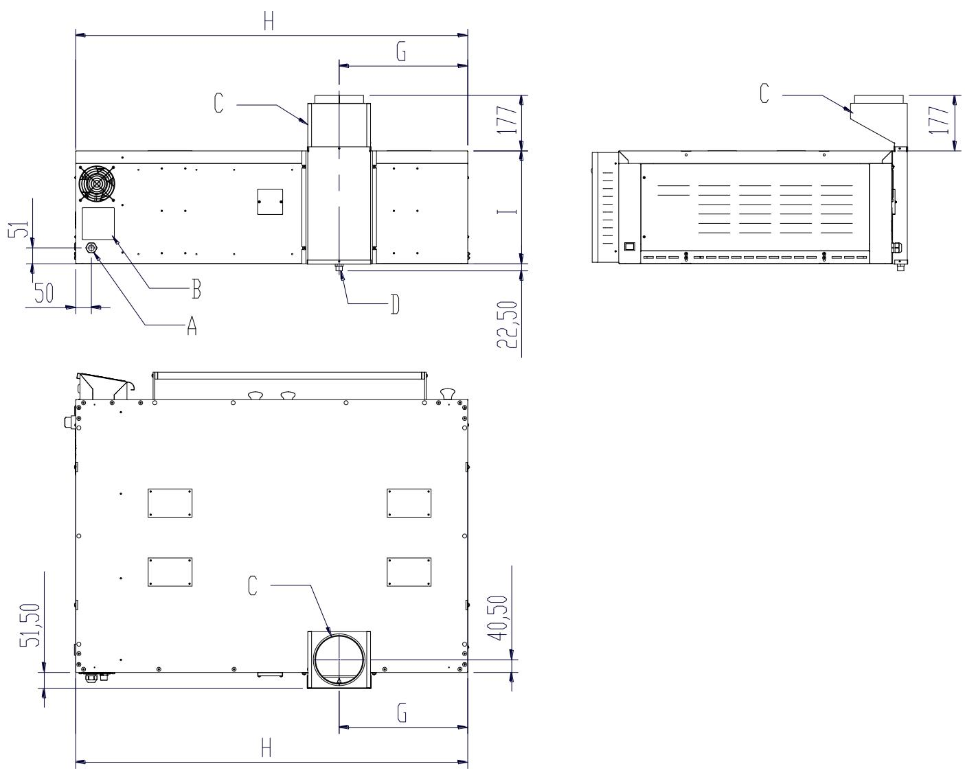
**Modulo con top / cappa aspirante 400m<sup>3</sup>/h, module with a top / 400m<sup>3</sup>/h hood, módulo con top / capa 400m<sup>3</sup>/h, module est avec top / hotte 400m<sup>3</sup>/h, Modul mit Oberteil / haube 400m<sup>3</sup>/h**
