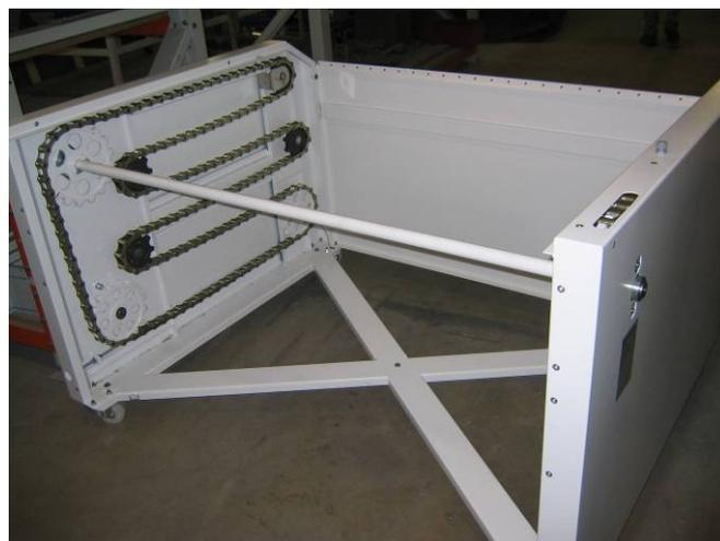
**FR** Assembler, sur le châssis n°2, les raidisseurs n°10 et 11, l'arbre moteur n°9 et le panneau avant n° 4. Ne pas serrer les vis à fond.
