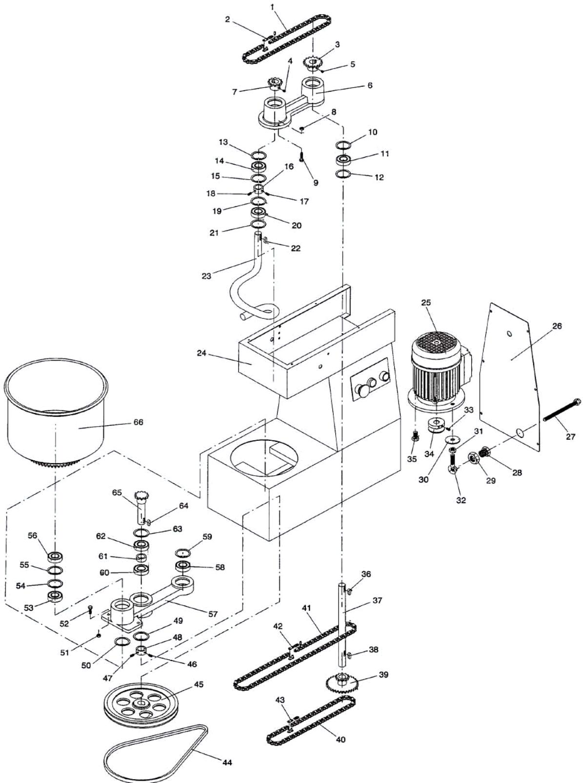
Fig. 7.1. GALASSIA - Componentistica di trasmissione
